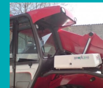
Engins équipés de cabine climatisée et pressurisée à air épuré
